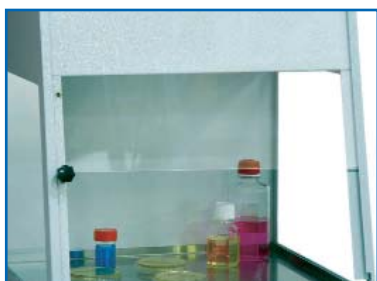
Il pannello frontale in policarbonato trasparente scorre verticalmente su appositi binari con movimento manuale
