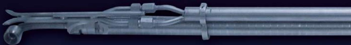
**I componenti della sonda a contatto con gli inquinanti sono realizzati totalmente in titanio e la misura della temperatura di campionamento come previsto dalla norma EN 1948, avviene all'interno della camera di campionamento a valle del setto filtrante.**
