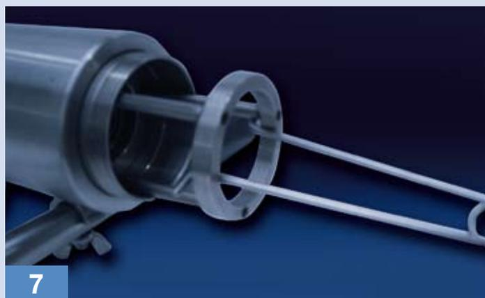
Estrazione dopo il campionamento dell'inserto con filtro mediante pinze divaricanti
