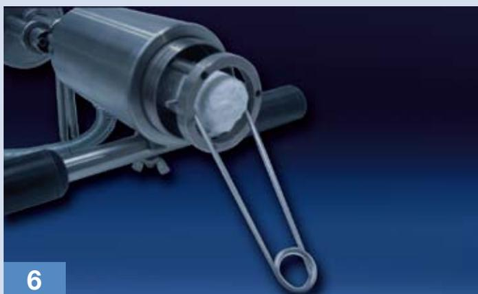
Estrazione dopo il campionamento dell'inserto con ditale mediante pinze divaricanti
