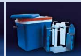
VALIGIA TERMICA completa di cestello portagorgogliatori in acciaio inox AISI 316 a 4 posti. Questa soluzione permette di mantenere i reattivi contenuti nei gorgogliatori a bassa temperatura prolungandone così nel tempo l'efficienza. Il raffreddamento può essere fatto tramite panetti per ghiacciaia.
