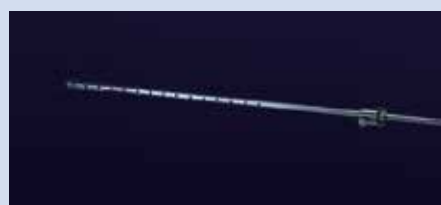
SONDA DI PRELIEVO GAS MULTIFORO a norme Unichim. Costruita in acciaio AISI 316. Completa di portagomma per il collegamento pneumatico e di attacco filettato per l'inserimento nelle flange delle sonde isocinetiche. E' disponibile con lunghezza 1 o 2 metri.
