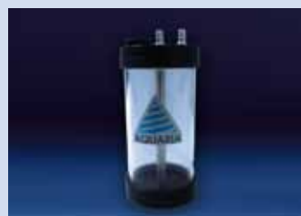
Il CILINDRO DEUMIDIFICATORE è costituito da una comoda e solida cartuccia in plexiglass caricabile con del comune gel di silice con viraggio di colore o con del carbone attivo, adatta a trattenere le eventuali condense il cui contenuto potrebbe essere corrosivo e quindi danneggiare la pompa in caso di accidentale aspirazione. Dimensioni: diam. 9 cm x 23 cm altezza
