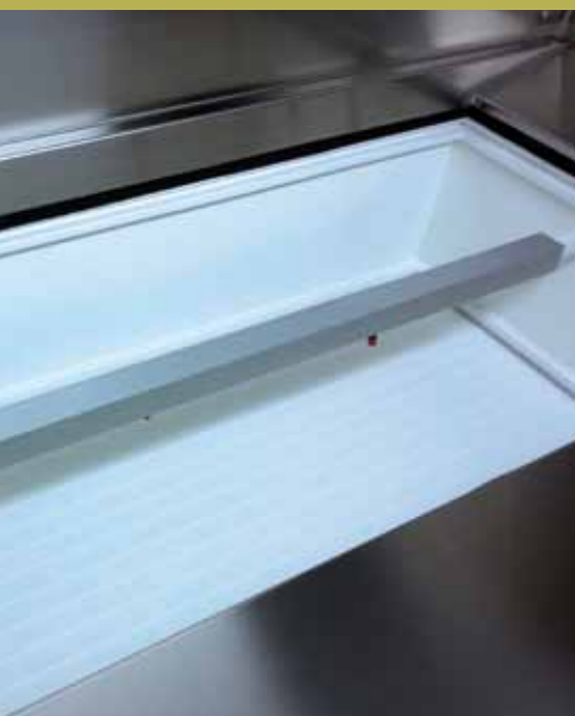
Filtro ULPA in fase di lavoro. Gli ugelli di colore nero posti sulla barra orizzontale nebulizzano la soluzione incapsulante
