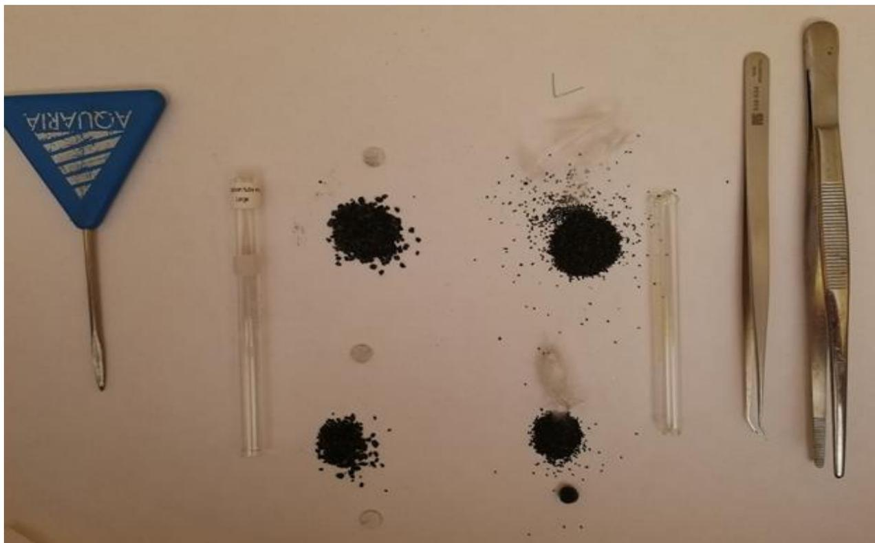
Figura 7. Materiali e tools impiegati per disassemblare le fiale adsorbenti. A sinistra strumenti e materiali per le fiale Aquaria. A destra strumenti e materiali necessari e costituenti le Fiale SKC
