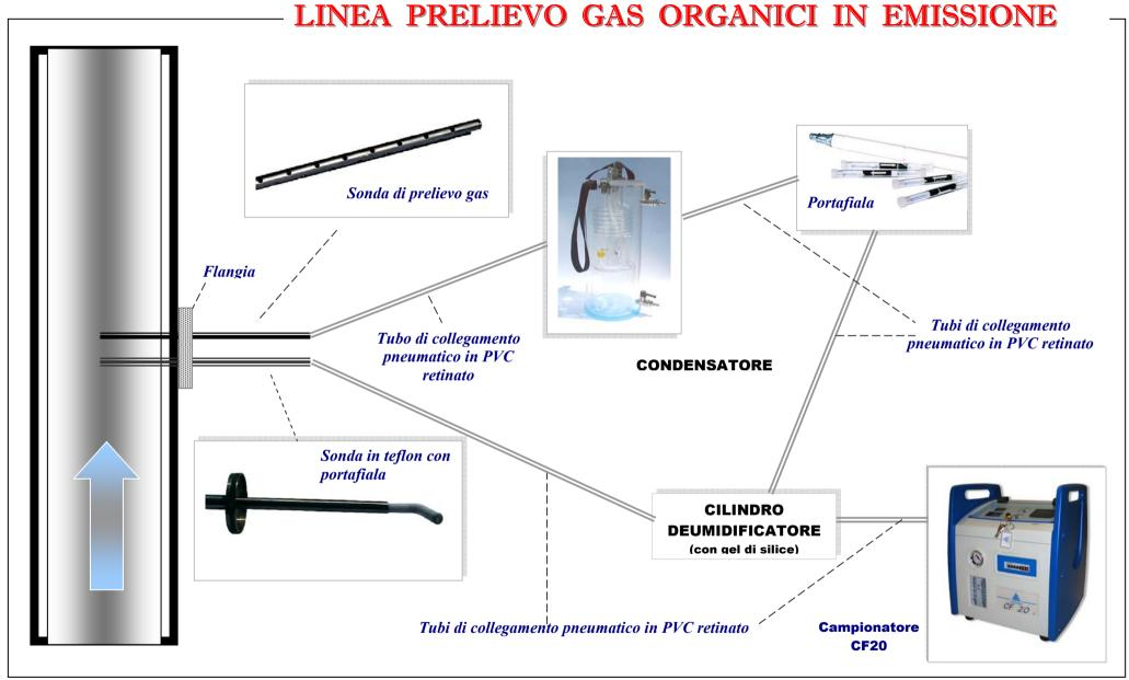
NOTE: La sonda in Teflon può essere usata solo per temperature massime di 150 °C
