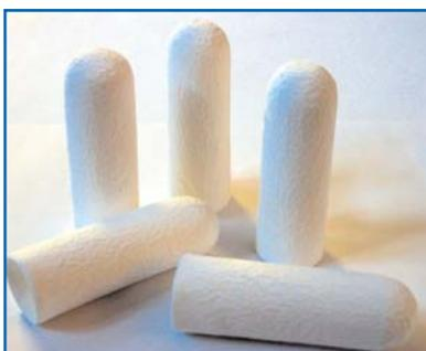
Sono inoltre disponibili **DITALI FILTRANTI** in cellulosa, fibra di vetro borosilicato e microfibre di quarzo di diverse dimensioni. Le tolleranze del diametro interno dei ditali sono inferiori al 1,5% consentendo quindi un'eccellente capacità di inserimento nei supporti di filtrazione
