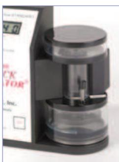
*Principio di funzionamento:* misura del flusso attraverso il passaggio di una bolla di sapone in un volume fisso nell'unità di tempo. Due sensori captano il passaggio del film di liquido attraverso il tunnel centrale della cella. Il primo sensore capta il film e attiva il timer che continua fino al secondo sensore. Il microprocessore divide il "volume fisso" tra i due sensori per il tempo trascorso e visualizza il flusso in cc/min.
